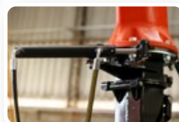
Giro da bica hidráulico
