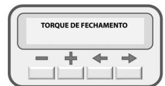
Para aumentar o torque de fechamento basta pressionar a tecla (+) até o nível de torque desejado e para diminuir basta pressionar a tecla (-).
