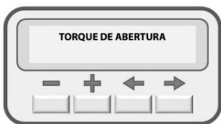
Para aumentar o torque de abertura basta pressionar a tecla (+) até o nível de torque desejado e para diminuir basta pressionar a tecla (-).
