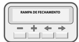
Para aumentar a rampa de fechamento basta pressionar a tecla (+) e para diminuir basta pressionar a tecla (-).
