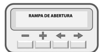
Para aumentar a rampa de abertura basta pressionar a tecla (+) e para diminuir basta pressionar a tecla (-).
