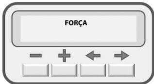
A força sai de fábrica no nível máximo, para diminuir basta pressionar a tecla (-) até o nível desejado, para aumentar basta pressionar a tecla (+).
