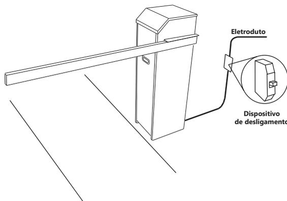
Obs: O dispositivo de desligamento total incorporado deve garantir o desligamento de todos os condutores da rede elétrica, exceto o Terra.
